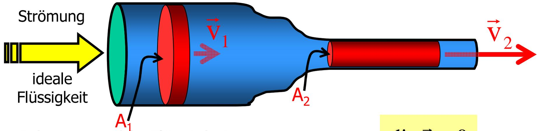
Inkompressible Flüssigkeit:  $\rho = \text{const.} \Rightarrow \text{div } \vec{v} = 0$
