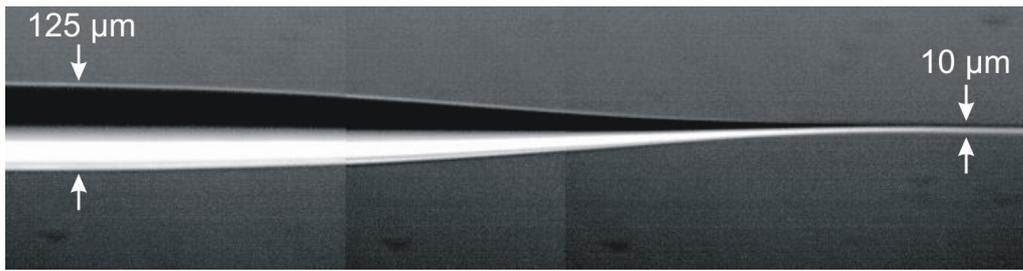
Abbildung 3.3: In der Ziehanlage verjüngte Glasfaser. Der Ausgangsdurchmesser beträgt  $125\ \mu\text{m}$ . Der Übergangsbereich ist zu Demonstrationszwecken sehr kurz gewählt worden.
