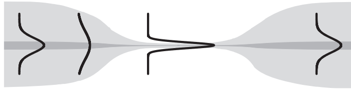
Abbildung 1.3: Schema zum adiabatischen Transfer der Mode vom Kern in den Mantel und zurück. Der Kern wird durch den dunkleren Bereich angedeutet.
