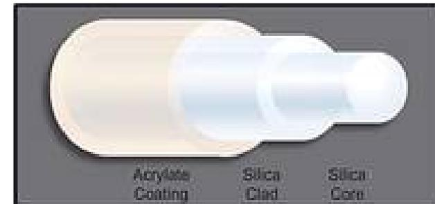
Ein strahlenoptisches Bild für die Lichtleitung ist nur anwendbar, falls:  $d \gg \lambda$
