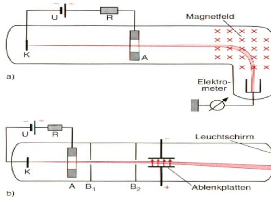
Abb. 2.34a,b. Anordnung von *J.J. Thomson* zur Bestimmung des Verhältnisses  $e/m$  der Kathodenstrahlung durch Ablenkung (a) im Magnetfeld, (b) im elektrischen Feld
