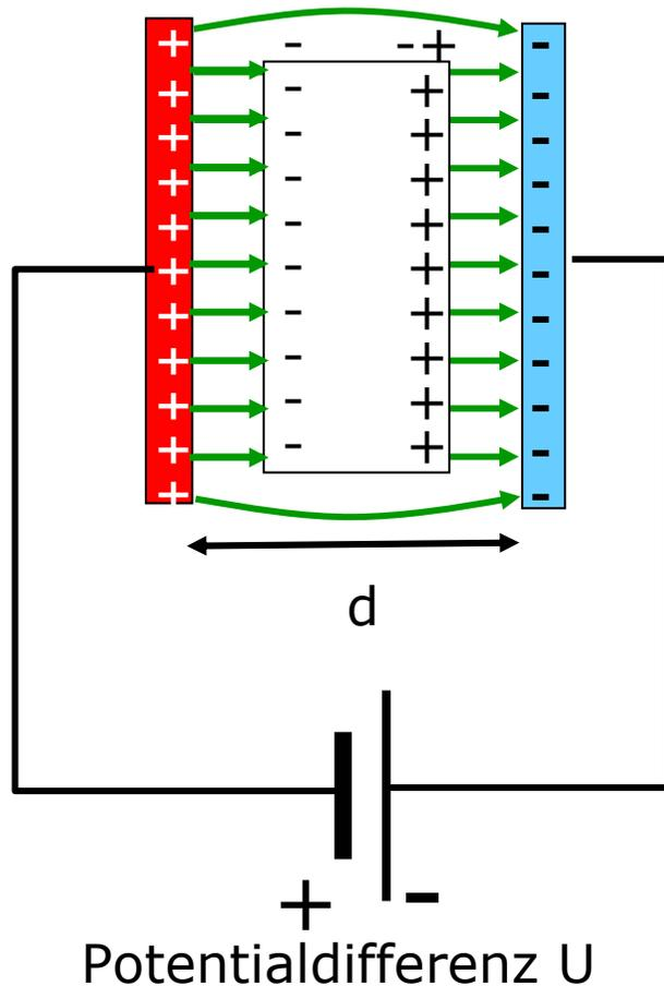
► Bei Isolator (Dielektrikum) zwischen den Kondensatorplatten passiert folgendes:
