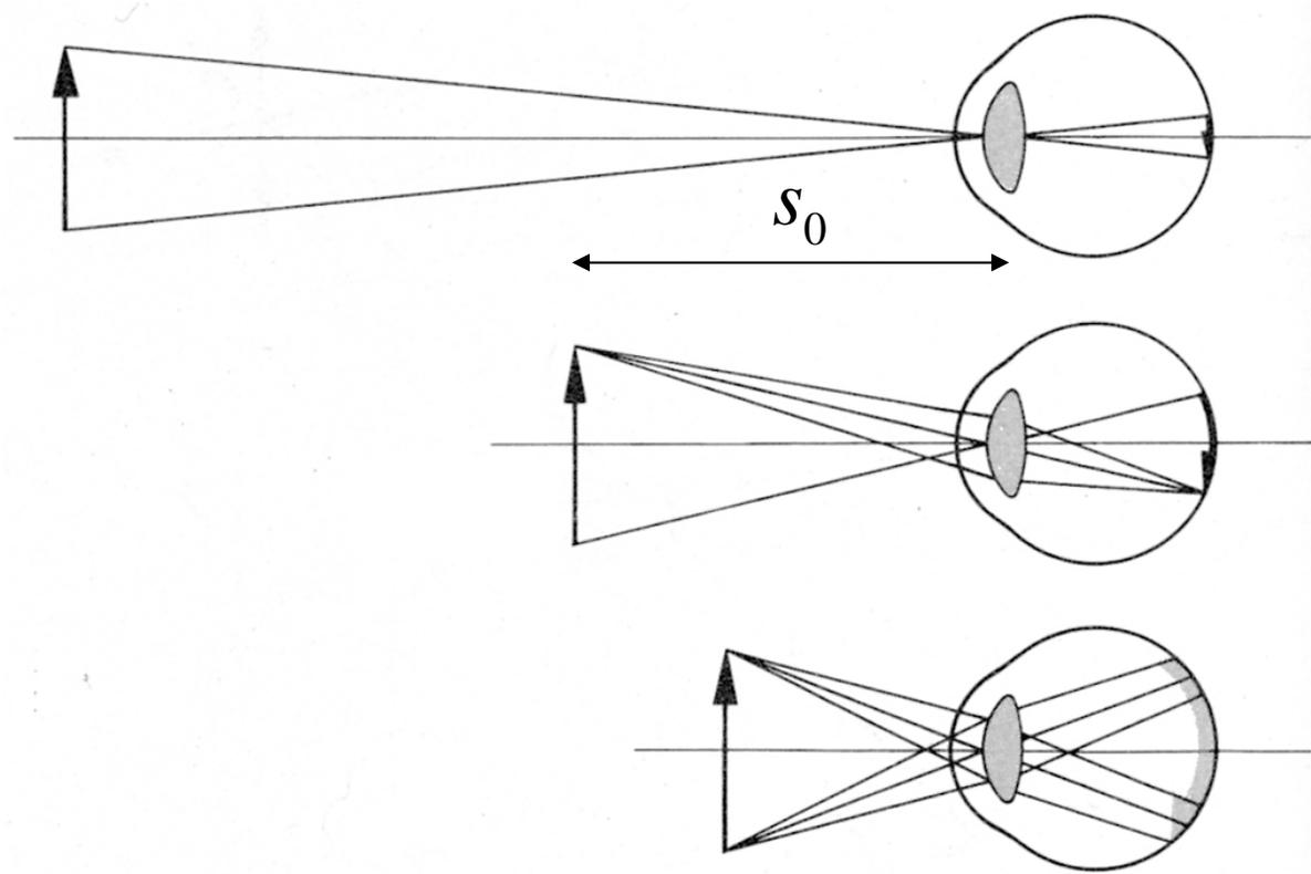
Optische Abbildung mit variabler Brennweite. Maximale Vergrößerung ist durch minimalen Sehabstand  $s_0$  begrenzt.
