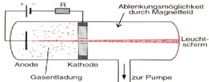
Abb. 2.35. Schematische Darstellung der experimentellen Realisierung von Kanalstrahlen in einer Gasentladung bei durchbohrter Kathode
