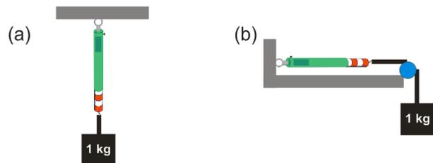
(b) In einer zweiten Anordnung läuft die Schnur zwischen Federwaage und Gewicht ( $1 \text{ kg}$ ) über eine Rolle. Das Gewicht hängt dabei über die Tischkante, während die Federwaage an der Wand befestigt ist. Welcher Wert wird nun angezeigt?
