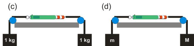
(c) In einer dritten Anordnung wird die Federwaage zwischen zwei  $1\text{-kg}$ -Gewichten eingespannt, die jeweils, von einer Rolle umgelenkt, über die Tischkante hängen. Welchen Wert zeigt die Federwaage an?
