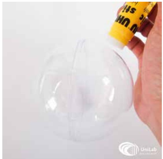
3. Auf die Trennscheibe den Stabmagneten kleben und darauf achten, dass der magnetische Südpol in Richtung des geographischen Nordpols weist.
