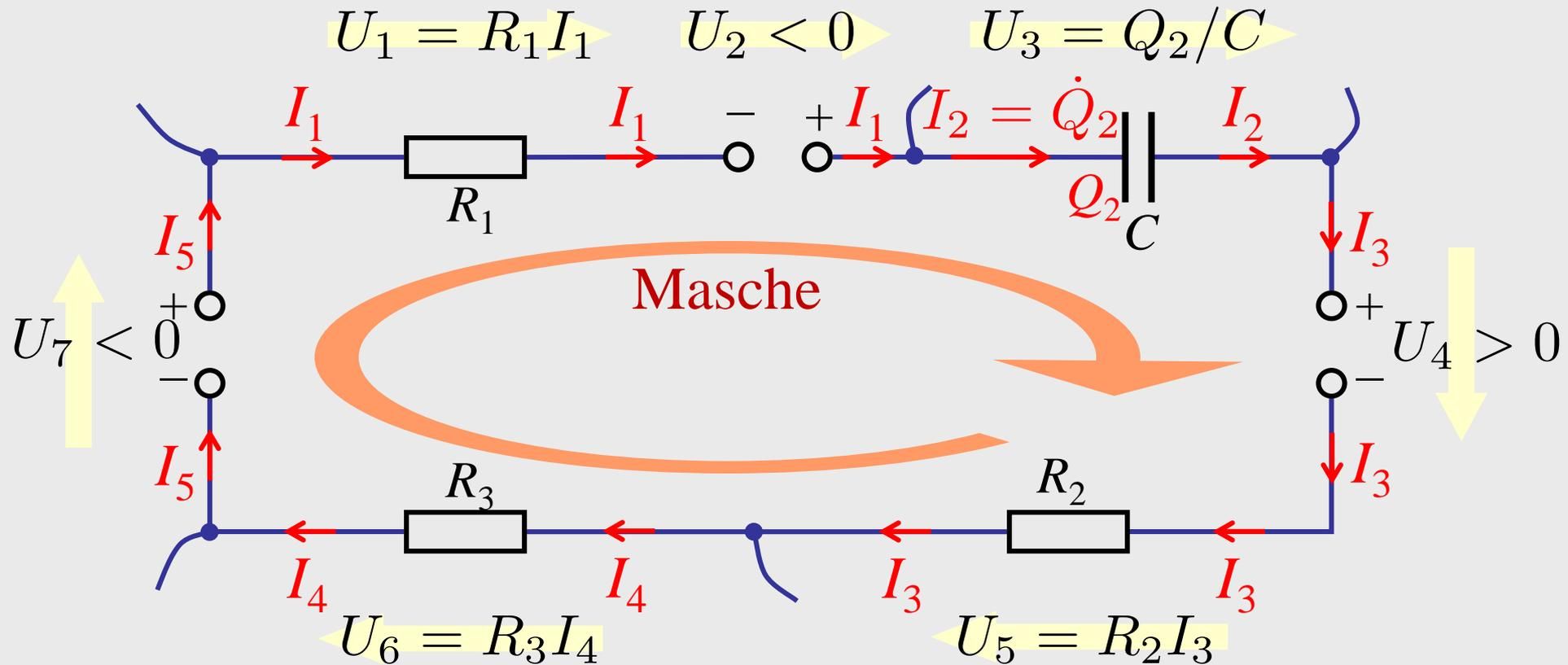
$$R_1 I_1 + U_2 + \frac{Q_2}{C} + U_4 + R_2 I_3 + R_3 I_4 + U_7 = 0$$
