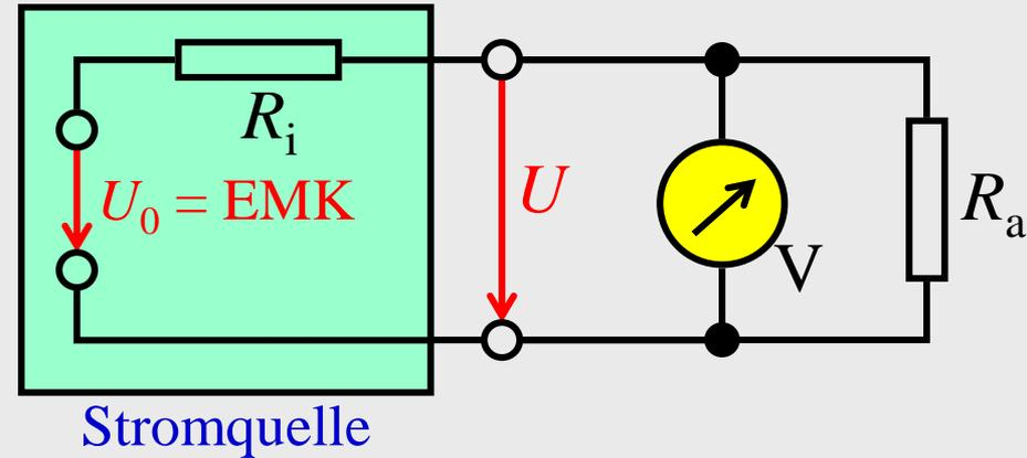
Messung von  $U(R_a) \Rightarrow$  Messung von  $R_i$  und **EMK**
