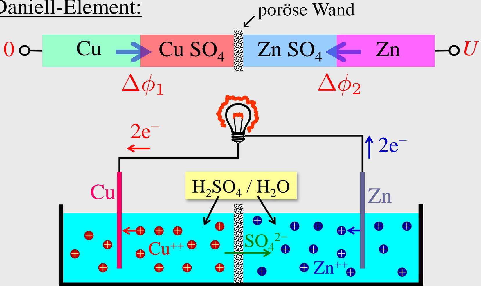
$$\Delta\phi = \Delta E = E(\text{Cu-Abscheidung}) - E(\text{Zn-Auflösung})$$
