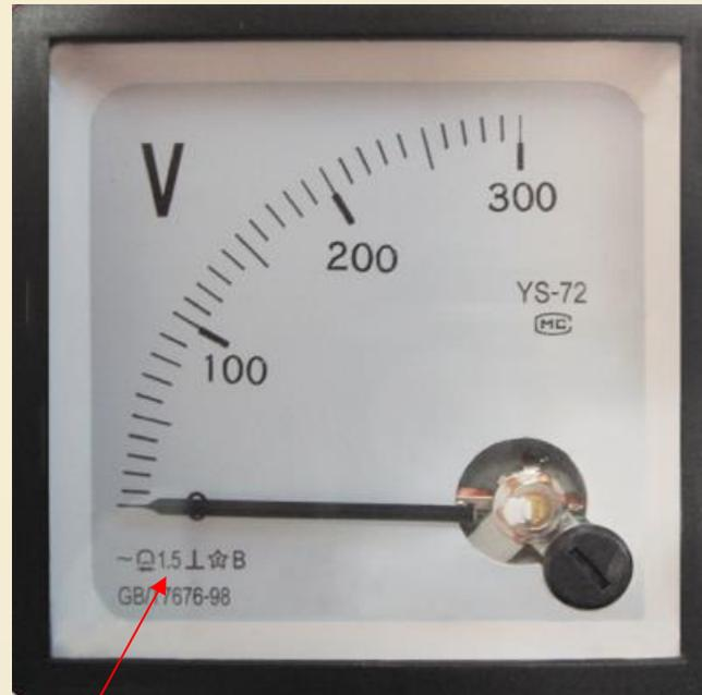
**Messung mit Analog-Voltmeter (Drehspulinstrument in senkrechter Lage)**
