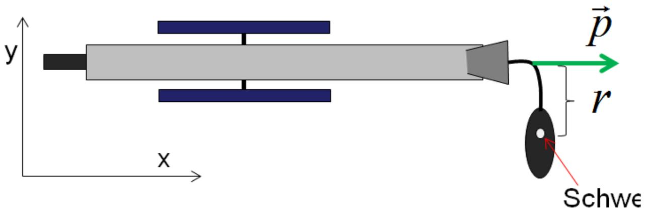
Die Länge des Vektors vom Schwerpunkt des asymmetrischen Stopfens zum Ansatzpunkt des übertragenen Impulses sei 25 mm in y-Richtung.
