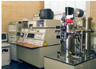
VG HB501-STEM 100kV, EELS/EDXS Max-Planck Institut für Metallforschung
