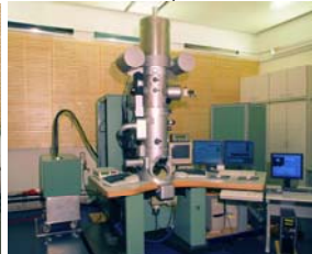
Zeiss Libra 200FE+MC 200kV, in column filter Max-Planck Institut für Metallforschung
