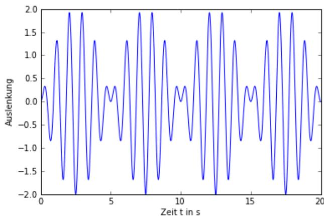
Nun betrachten wir einmal gekoppelte Fadenpendel, die über eine Feder mit der Federkonstante  $k_f$  gekoppelt sind.
